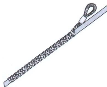
Chaussette de tirage du câble.
