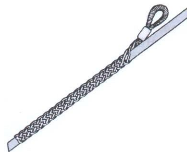
Chaussette de tirage du câble.
